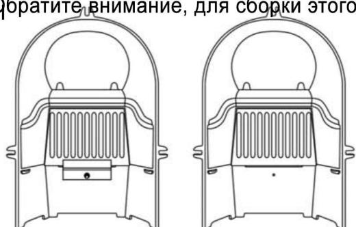
Снимите удерживающую пластину огнеупорного камня, удалив крепление M6. В случае использования твердого топлива этот шаг не требуется.
