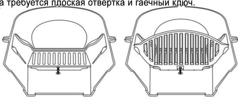
Положите топливник на ровную поверхность. Поместите огнеупорный камень на место и затем вставьте 1 болт M6 в отверстие прямо под ним. Вставьте колосник в пазы топливника над гайкой M6. Закрепите с помощью шайбы M6 и болта M6.
